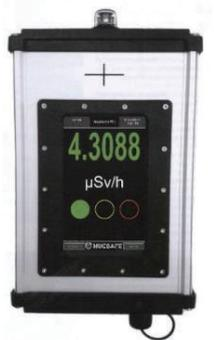
GM 管方式の可搬型エリアモニタ。
