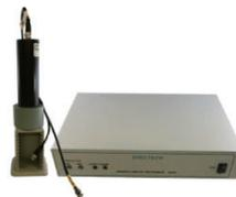
Spectech 社 UCS30 は 1k/2k/4kch MCA と高圧電源(1000V)、プリアンプ、アンプを内蔵したシンチレーション検出器用の教育システムです。
