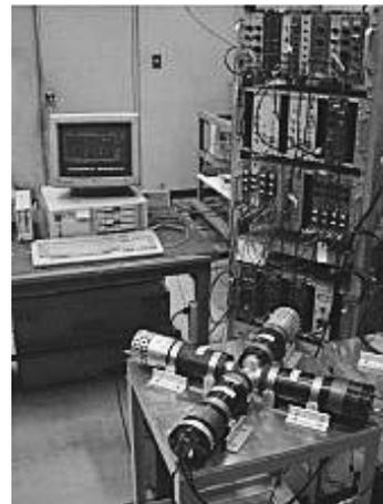
図1 4台の $\gamma$ 線検出器（BaF<sub>2</sub>）と電子回路
