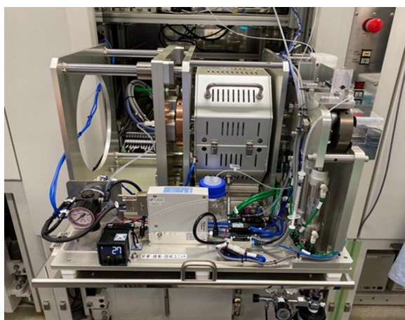
図1. [^{211}\text{At}]\text{NaAt} の自動合成装置
